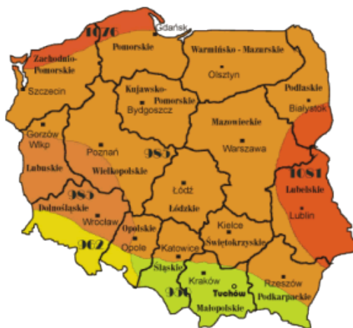
Rysunek 4. Rejonizacja średniorocznych sum promieniowania słonecznego całkowitego padającego na jednostkę powierzchni poziomej w kWh/m 2 /rok. Liczby wskazują całkowite zasoby energii promieniowania słonecznego w ciągu roku dla wskazanych rejonów kraju
